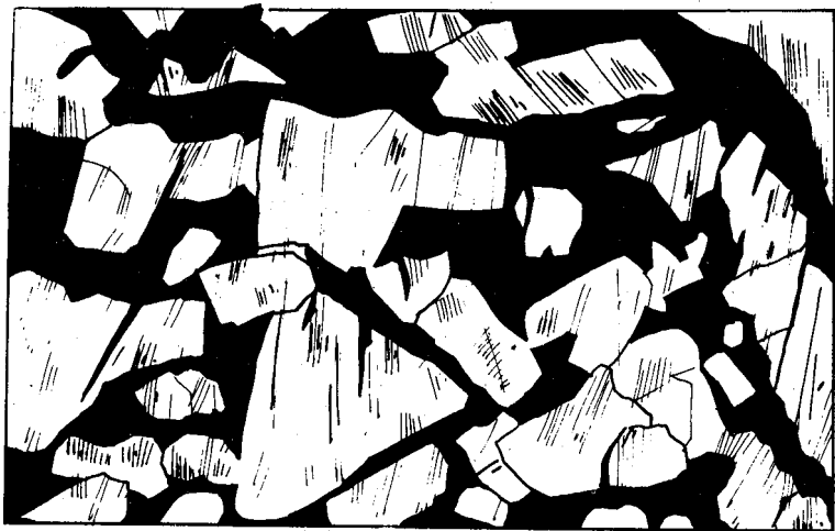
26-расм. ВК15 маркали қаттиқ қотишманинг микроструктураси.
