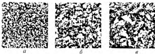
Рис. 5.2. Структура образцов полипропилена (увеличение \times 200 ): а — закаленного; б — прессованного; в — отожженного
