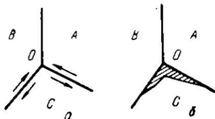
Рис. 33. Схема зарождения трещины в стыке трех зерен за счет межзеренной деформации (Чэнг, Грант)
