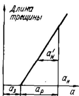
Рис. 99. Схема разделения ударной вязкости на составляющие (Отани)
