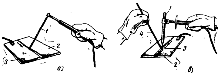
4- расм. Ёй ёрдамида дастаки пайвандлаш: а—металл электрод билан, б—кўмир электрод билан
