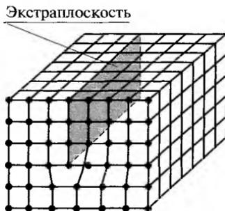
Рис. 2.6. Линейный дефект кристаллической решетки — краевая дислокация
