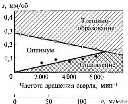
Рис. 9.4. Влияние режимов сверления на качество поверхности полиметилакрилата
