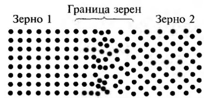
Рис. 2.9. Размещение атомов внутри зерна и на границе между зернами
