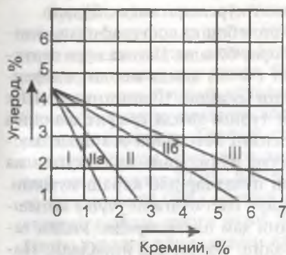
94-расм. Чўян таркибдаги кремний ва углерод миқдори (а) ҳамда қуйма қалинлигининг тузилишга таъсири (б).
