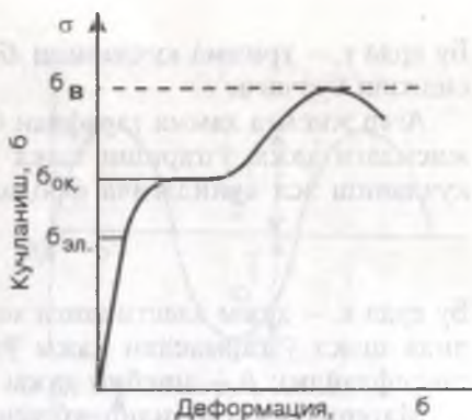
19-расм. Металлар учун чўзиш диаграммасининг умумий қўриниши.
