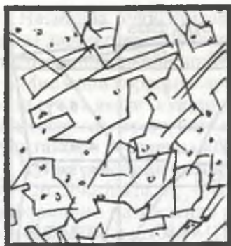
103-расм. Бир фазали \alpha — латун (а) ва икки фазали \alpha + \gamma — латун (б)ларнинг микротузилиши.
