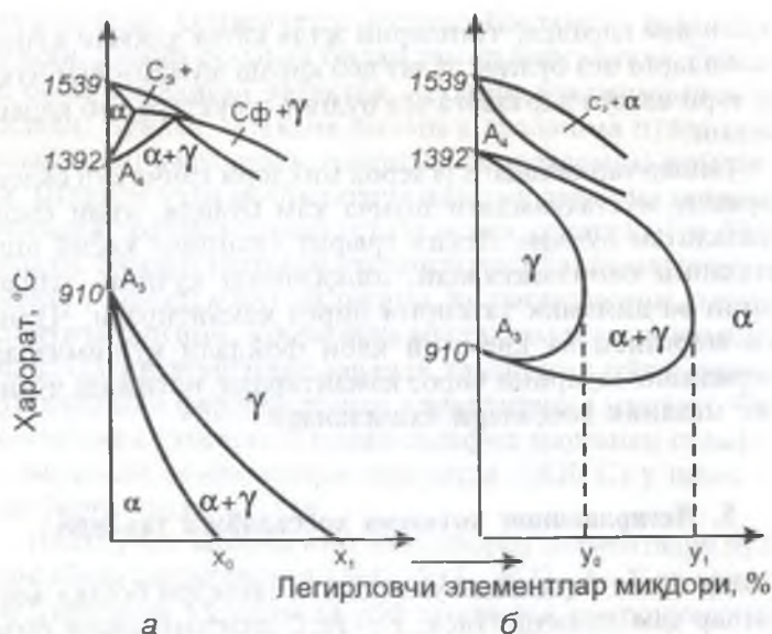
64-расм. Пўлат таркибидаги легирловчи элементларнинг темсир полиморф ўзгариш температурасига таъсири.
