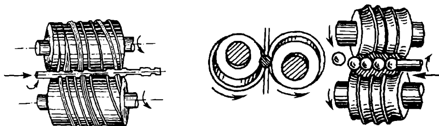
101-расм. Кўндалангига прокатлаш: шатун поковкасини (а) ва шарларни даврий прокатлаш (б)
