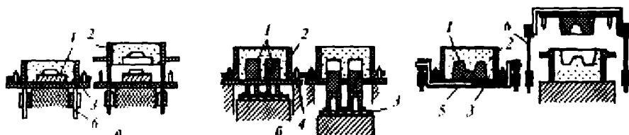
167-расм. Қолипни ажратиш усуллари: а — опокани кўтариб ажратиш; б — моделни тушириб ажратиш; в — модель плитани айлантириб кўтариб моделни ажратиш: 1 — модель; 2 — опока; 3 — модель плита; 4 — тортиладиган плита; 5 — айланадиган стол; 6 — штифтли механизм
