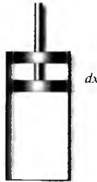
Рис. 2.1. Цилиндр с поршнем, перемещающимся без трения
