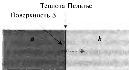
Рис. 5.20. Перенос тепла посредством электрического тока
