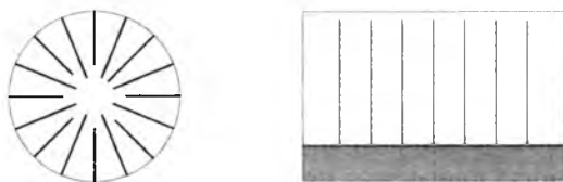
Рис. 12.19. Типичные коллекторные схемы сбора электроэнергии, вырабатываемой фотодиодом
