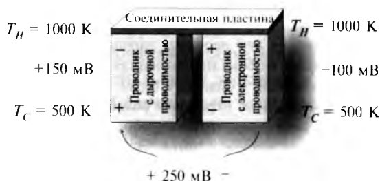
Рис. 5.18. Термопара из двух материалов с проводимостью различного типа
