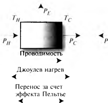
Рис. 5.21. Направление тепловых потоков в термопаре, используемой как генератор
