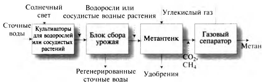
Рис. 11.7. Схема комбинированной установки по очистке сточных вод, производству удобрений и метана
