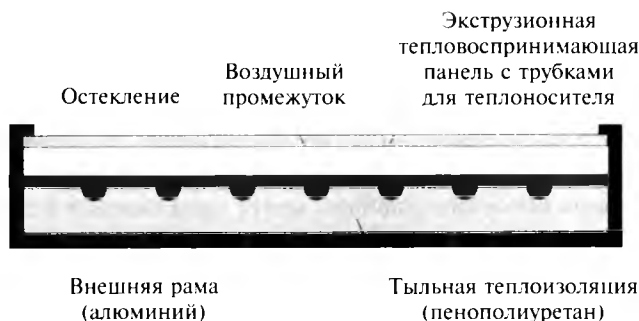
Рис. 10.7. Поперечное сечение типового плоского коллектора
