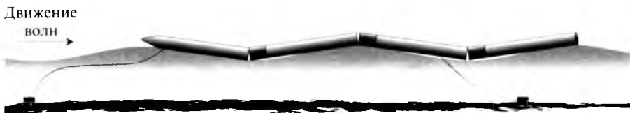
Рис. 14.3. Шарнирный контурный преобразователь Pelamis
