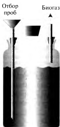
Рис. 11.4. Лабораторный метантенк (установка для анаэробного сбраживания)
