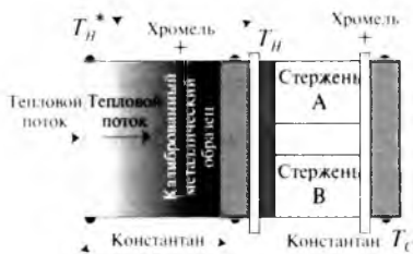
Рис. 5.6. Схема измерения теплового потока в термопару
