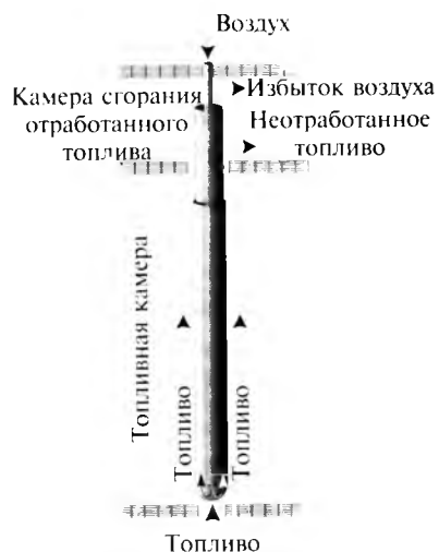
Рис. 7.11. Цилиндрические элементы собраны в модули без использования уплотнений
