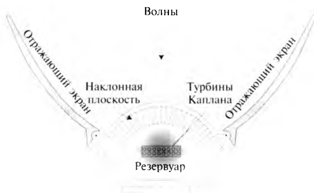
Рис. 14.4. Установка Wave Dragon (вид сверху)
