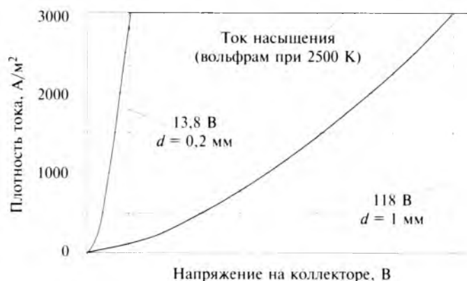
Рис. 6.6. I, J - характеристики двух вакуумных термоэмиссионных диодов
