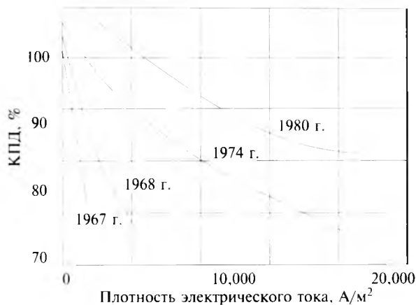
Рис. 8.5. Повышение эффективности электролитических ячеек в результате их усовершенствования на примере зависимости КПД от плотности тока для различных моделей электролитических ячеек фирмы General Electric
