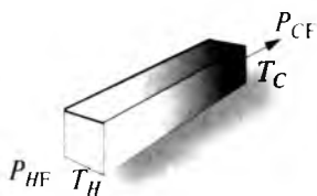
Рис. 5.1. Стержень с разными температурами на торцах
