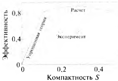
Рис. 13.18. Зависимость эффективности ветроколеса от компактности S
