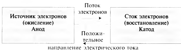
Рис. 7.1. Электрохимический элемент должен содержать источник и сток электронов
