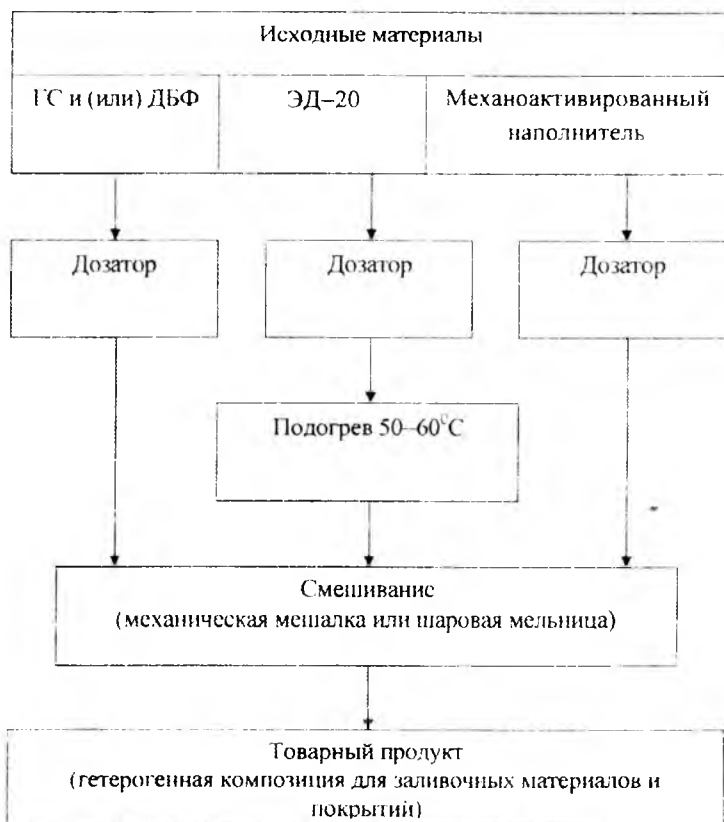
Рис. 4.10. Технологическая схема получения композиций для заливочных материалов и покрытий
