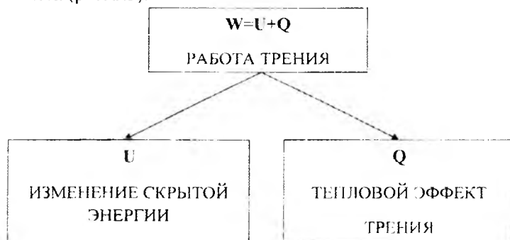
Рис. 2.3. Схема энергетического баланса процесса трения[66]
