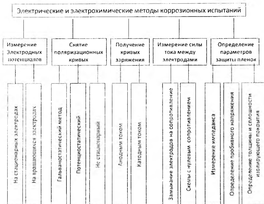
Рис. 5.1. Методы коррозионных испытаний, основанные на измерении электрических величин
