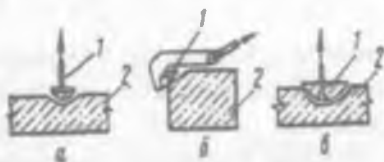
7.12– rasm. Inshootlar elementlarini buzush ta'siriga asoslangan asboblarning ishlash sxemalari: a – GPNV-5; b – URS moslamasi bilan GPNV-5; v – GPNS-4; 1 – buzuvchi element; 2 – tadqiq qilinadigan namuna
