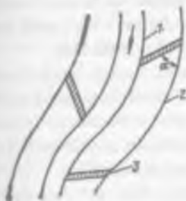
8.1 – rasm Tiqilish hosil bo'lishiga qarshi kurashish uchun Dubossar suv omboridagi yarim zaprudalarni joylashuvi:
