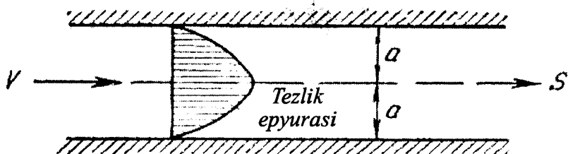
6.2-rasm. Ikkita parallel plastinka orasidagi kichik tirqishda suyuqlik xarakati
