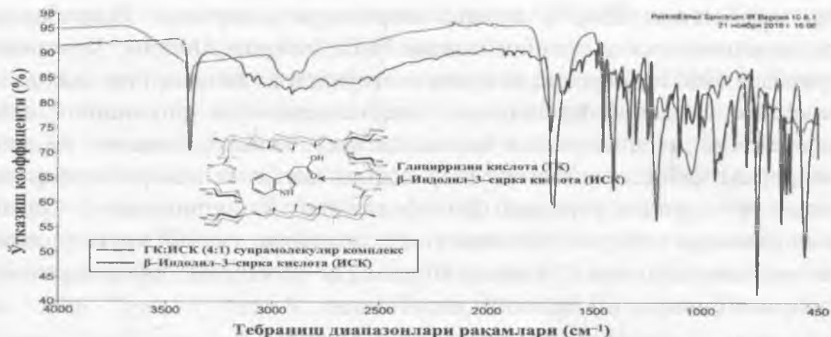
1-расм. ГК:β – Индолил – 3-сирка кислота (ИСК) супрамолекуляр комплексининг ИҚ – Фурье спектрлари.
