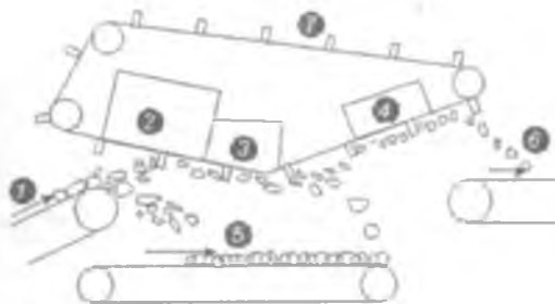
Rasm 21.5. QMCh tarkibidan qora metallarni magnit separatsiyasi usulida ajratib olish sxemasi:
