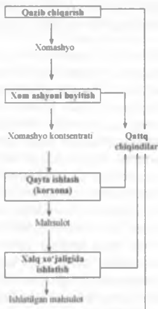
21.1-rasm. Mahsulot ishlab chiqarishda qattiq chiqindilarning hosil bo'lish manbalari:
