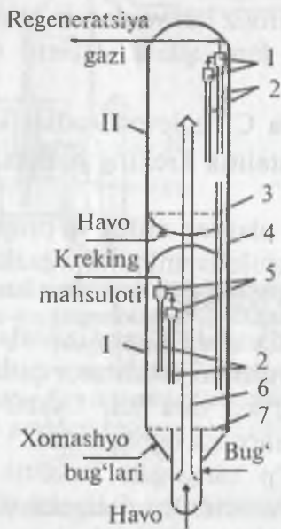
6.24-rasm. Flyuid kreking jarayoni reaksiya tarmog'i sxemasi:
