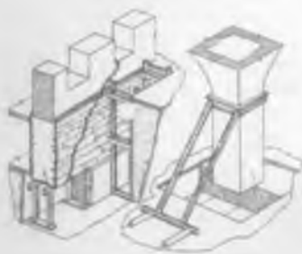
3.7.6-rasm (davomi). Chuqur poydevor tagiga temirbeton o'rnatish.
