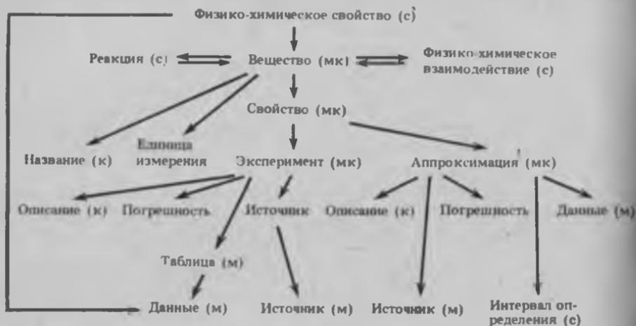
Рис. 4.8. Структура базы данных «Физико-химические свойства»
