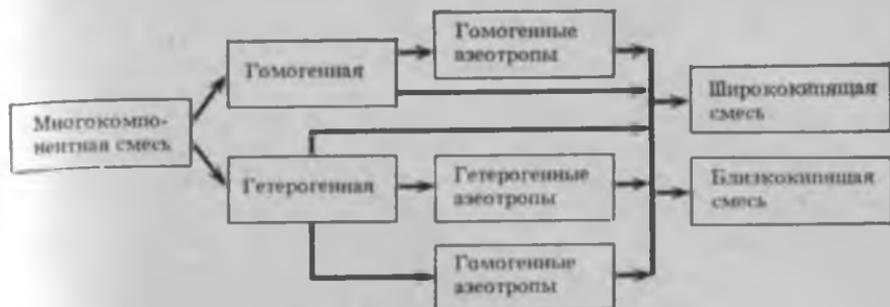
Рис. 4.6. Взаимосвязь свойств многокомпонентной смеси
