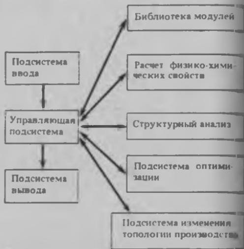
Рис. 4.15. Обобщенная структура моделирующей системы
