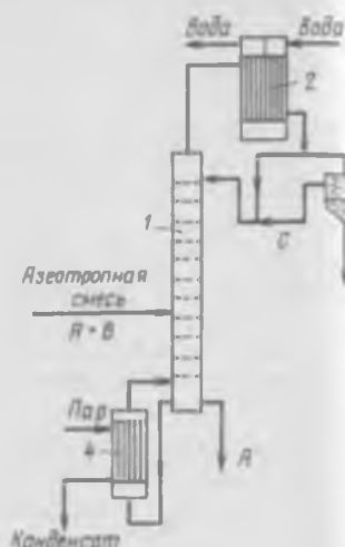
Рис. 17-32. Схема установки для экстрактивной ректификации бинарной смеси:
