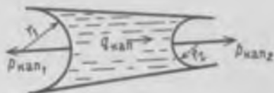
рис. 19-3. К механизму массопереноса внутри поры твердого тела под действием капиллярных сил
