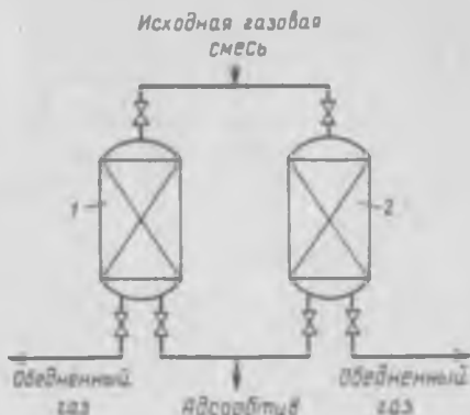
Рис. 20-8. Схема короткоцикловой безнагревной адсорбционной установки (1, 2—адсорберы)
