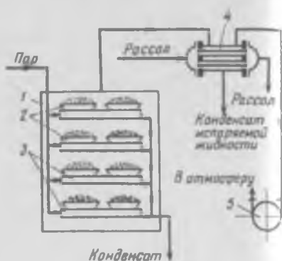
Рис. 21-26. Установка с вакуум-сушильным шкафом:
