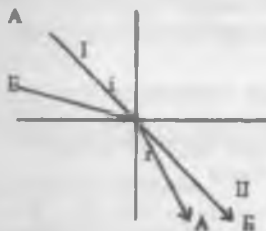
2-расм. А ва Б нурларининг камзич муҳитдан зич муҳитга ўтишидаги синиши. Бурчак i > r , v_1 > v_2 ва n_1 < n_2 .
