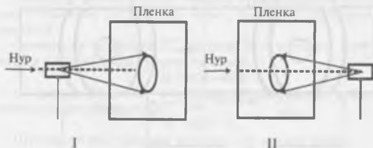
58-расм. Ясси плёнкага тасвир туширишда рентген нури йўналиши, намуна ва плёнкаларни жойлаш схемалари: I-нур ўтишига асосланган; 2-нур қайтишига асосланган.
