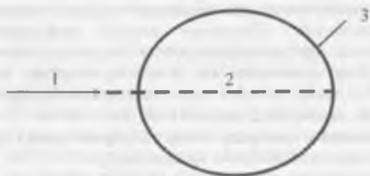
56-расм. Асимметрик тасвир усули камераси: 1-рентген нури; 2-камера; 3-плёнка.
