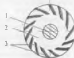
Рис 3 Схема центробежного компрессора 1 - вал, 2 - рабочее колесо, 3 - лопатки
