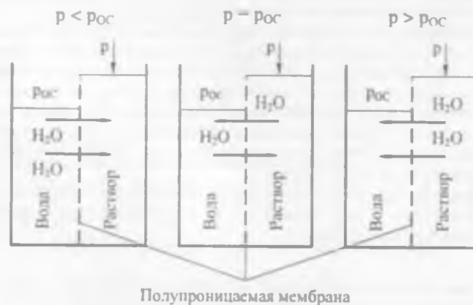
Рис 23 Схема разделения раствора обратным осмосом
