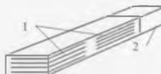
Рис 24 Устройство плоского мембранного модуля: 1 – мембранный модуль, 2 – корпус
