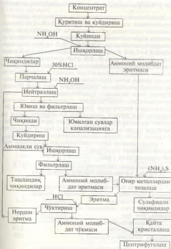
25- расм. Кислотали парчалаш усулида молибден олиш технологик схемаси.
