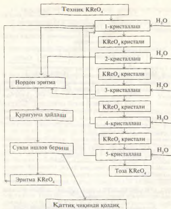
42-расм. Калий перренатни қайта кристаллаш орқали тозалашнинг технологик схемаси.
