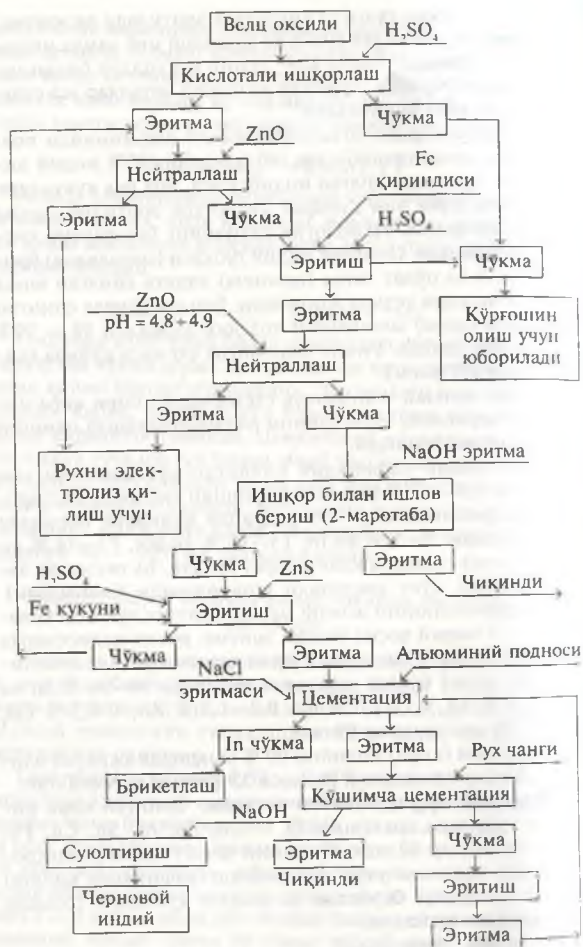
37-расм. Велъц оксидларидан индийни олиш технологик схемаси
