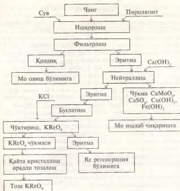
41-расм. Перанат ренийни чанглардан ажратиб олишнинг технологик схемаси.
