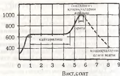
34-расм. \text{GeO}_2 ни қайтариш шароити ва ундаги германийли қошиқчаларнинг ўчоқда ҳаракатланиши.
