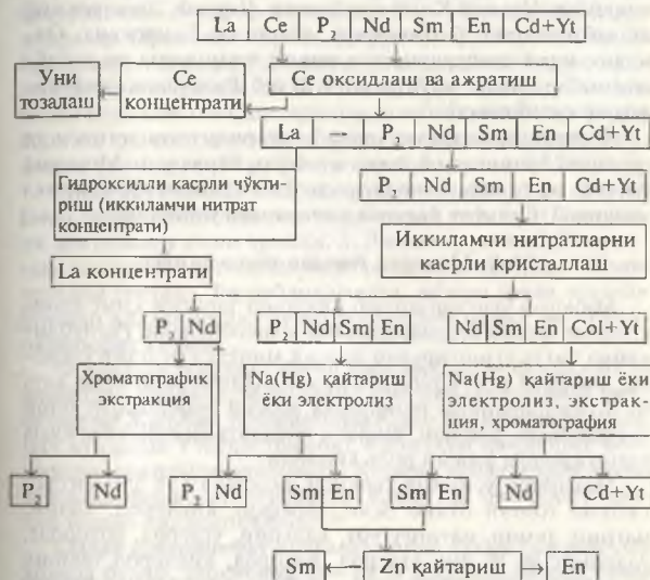
50- расм. Церий группасидаги элементларни бир-биридан кетма-кет ажратиб олиш технологик схемаси.
