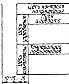
Рис. 12.9. Графическое исполнение поясняющих надписей в электрических схемах
