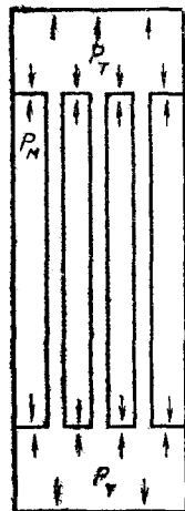
Рис. 80. К расчету усилий в теплообменнике
