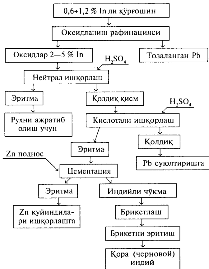
38-расм. Рух қорасини рафинациялашда ҳосил бўлган қўроғшин таркибидаги индийни ажратиб олиш технологияси.
