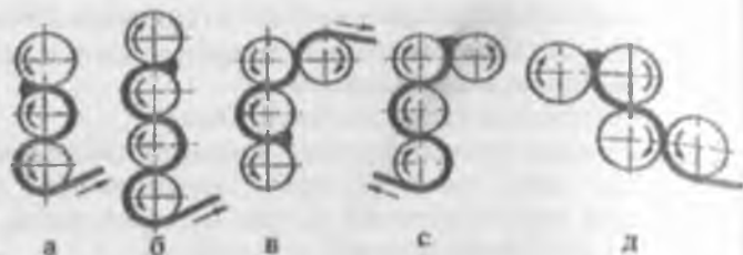
6.8 – расм. Резина коришмаларини варақалашда валикларнинг жойланиш схемаси:
