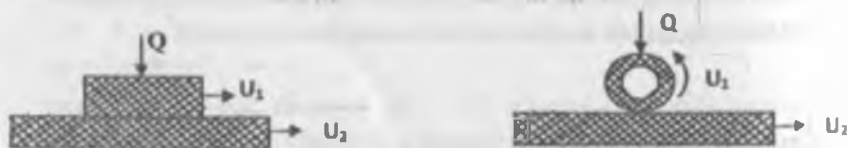
5.9 - расм. Намуна юзасининг ейилиши схемаси:
