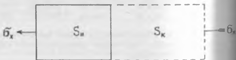
7.20 – расм. Полимер пардасини бир ўқ бўйлаб ориентирлаш схемаси
