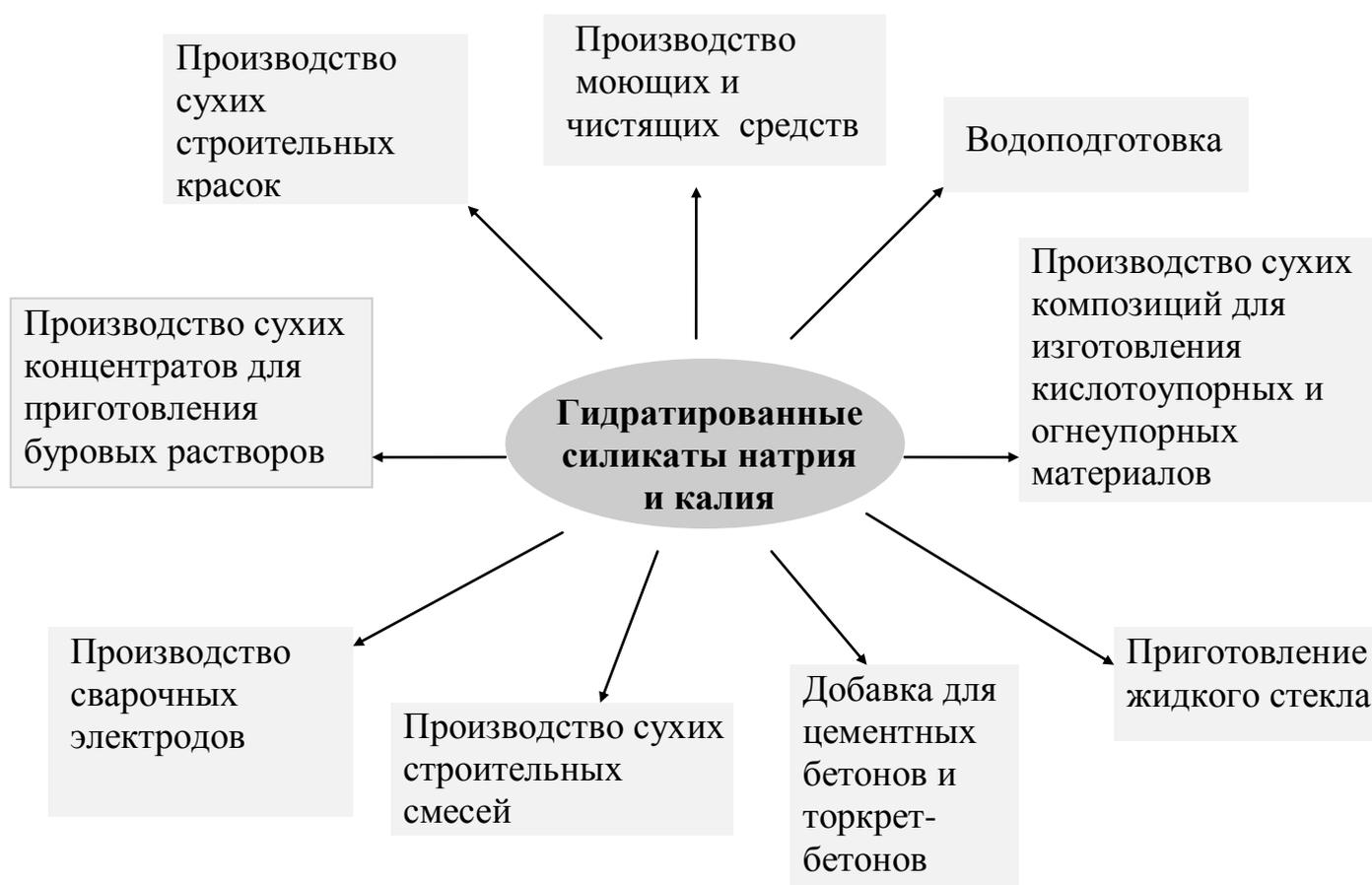
Рисунок 24 - Области применения гидратированных порошков силикатов щелочных металлов.
